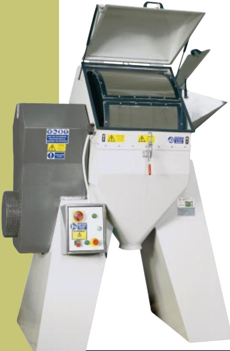
Il molino a sfere serve per ridurre in polvere finissima il materiale incenerito nonché crogoli, boraci e residui contenenti metalli preziosi, allo scopo di poter, successivamente, omogeneizzare tale polvere e determinare il contenuto dei metalli preziosi in essa contenuta. Il molino è costruito interamente in lamiera di ferro.
