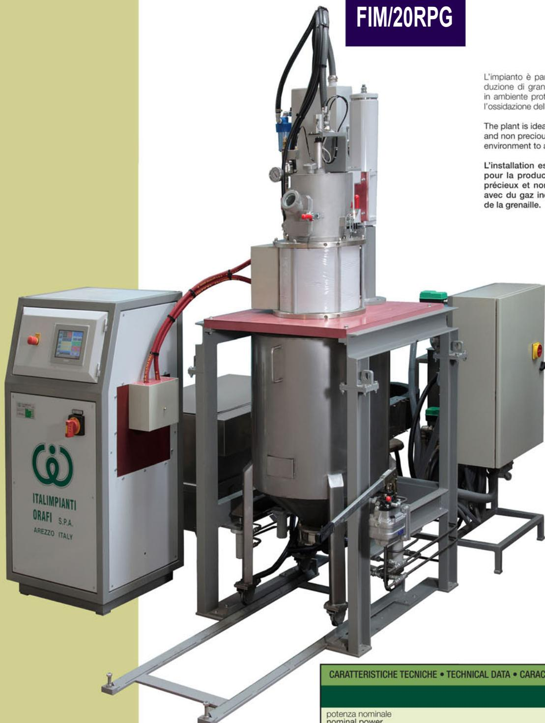
L'impianto è particolarmente adatto alla produzione di graniglia di leghe preziosi e non, in ambiente protetto da gas inerte per evitare l'ossidazione della stessa.
