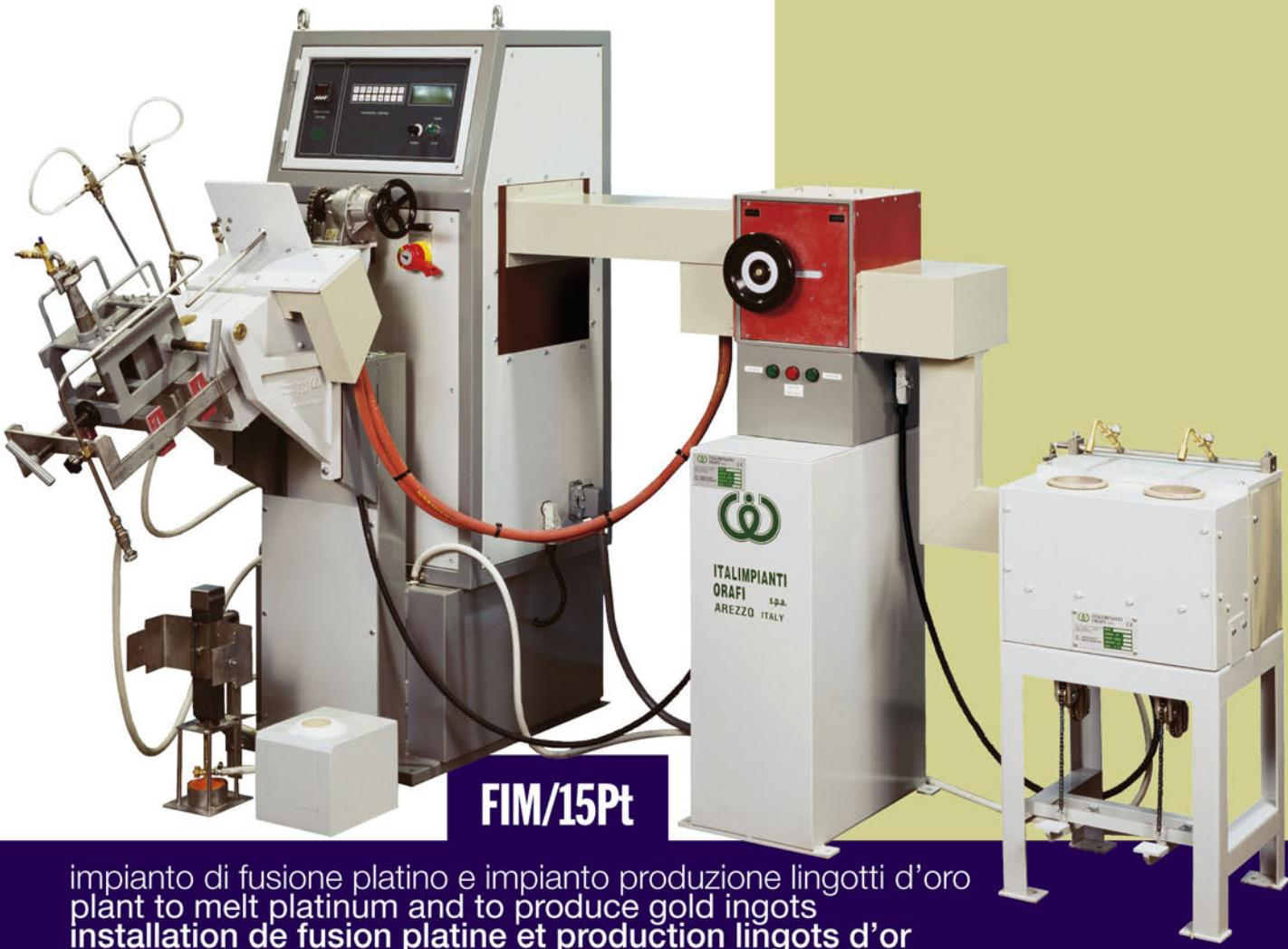
impianto di fusione platino e impianto produzione lingotti d'oro
