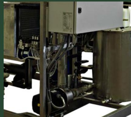
L'impianto è dotato di un sistema di riscaldamento basato sulla pompa di calore, opera sotto 5 kPa e ad una temperatura di circa 30°C. Lo scambio di calore avviene grazie ad una camicia conica riscaldante, mentre la parte interna della camera di ebollizione è pulita da raschiatori interni che mescolano continuamente il concentrato.
