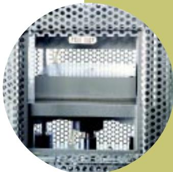
La vulcanizzatrice serve per la preparazione di stampi di gomma. Si compone di un mobile in lamiera di acciaio verniciato che sorregge la presa idraulica a 4 colonne, con piastre riscaldanti in ghisa da 250x250 mm. Il vantaggio principale di questa macchina è l'automazione di tutto il ciclo, lasciando quindi libero l'operatore per tutta la durata del processo. Altri vantaggi sono:
