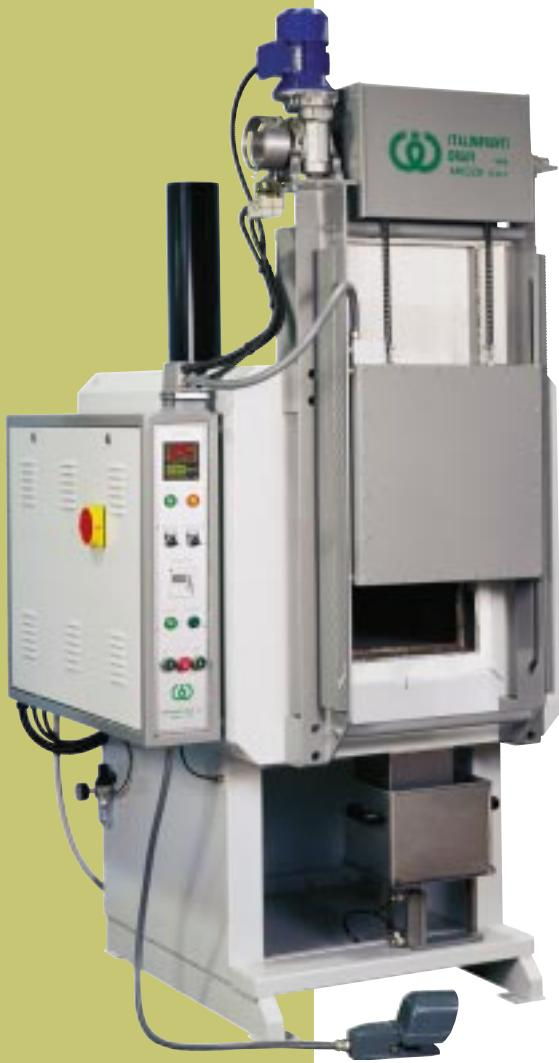
Il forno è adatto per l'essiccazione e la cottura delle forme di rivestimento refrattario per fusione a cera persa. Le principali caratteristiche sono le seguenti:
